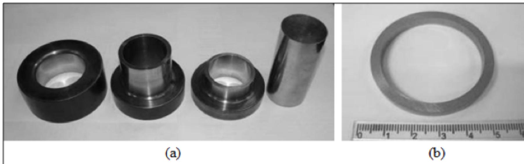
Para análise da dureza e tensão de escoamento das ligas estudadas foi utilizada a matriz da figura 2-a, cujos corpos de prova obtidos possuem a forma de cilindros (figura 2-b).
